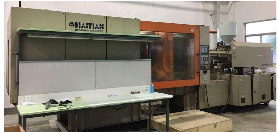
Injection Molding Machine 【800ton】
