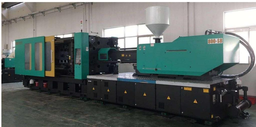
バンパー、インパネ等の大型パーツは中国トライアウトセンターの1600～3500トン成型機にて対応をしています。
